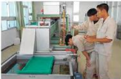
水理実験の様子。水を流して流れ方や勢いを確認することで、川の形状を検討する
