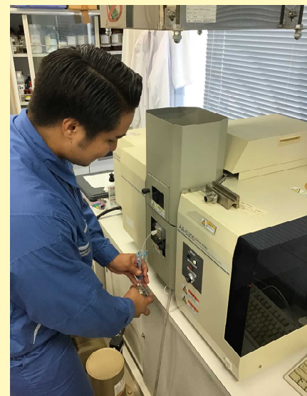
原子吸光分析装置を使って試料中のMgを定量
